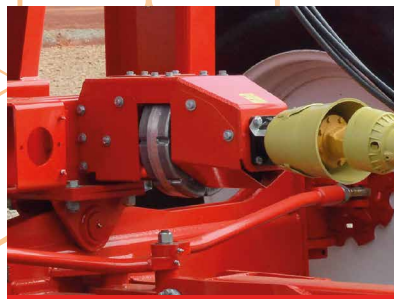
EMBREGEM ELETROMAGNÉTICA: Acionada por controle remoto para movimentar o tubo multiuso.
